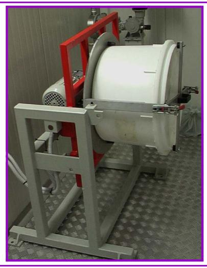
Il mixer per polveri di P.T.F.E. è una macchina accessoria per il mixaggio di polveri fini di P.T.F.E. con relativo lubrificante Iso-paraffinico.
